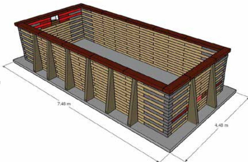
POSE HORS-SOL/SEMI-ENTERRÉE (1/3 ENTERRÉE) 16X RENFORTS OBLIGATOIRES
